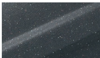
Strukturlack SL 94 Pulverbeschichtung, Metallic-Feinstruktur matt (ähnlich DB 703 Feinstruktur)
